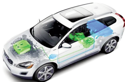
Şəkil 1. Hibrid avtomobilində hissələrin yerləşməsi sxemi
