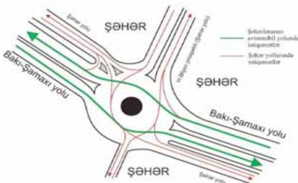
*Şəkil 2. Dairəvi nəqliyyat açılmasında nəqliyyat axınlarının hərəkət istiqamətləri*
